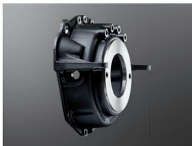
Für den Anbau der Hydraulikpumpen am Dieselmotor liefert die KTR gemäß der SAE-Anschlussabmessungen Anschlussflansche in den Nenngrößen SAE 6 bis SAE 1. Gefertigt werden diese Flansche aus Stahl und EN-GJL-250 für Hydraulikpumpen mit Flanschschlüssen nach SAE-A, -B, -C, -D und -E in 2-Loch- sowie 4-Loch-Ausführung.
