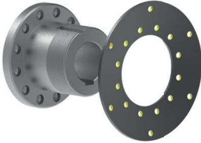
Wird das eingestellte Drehmoment überschritten, tritt zwischen An- und Abtrieb eine Relativbewegung auf. Das übertragbare Drehmoment fällt auf einen geringeren Restwert ab. Die Kugeln verlassen die Senkungen der Tellerfeder. Nach Beseitigung der Überlast können die Kugeln wieder in die Senkungen der Feder einrasten.
